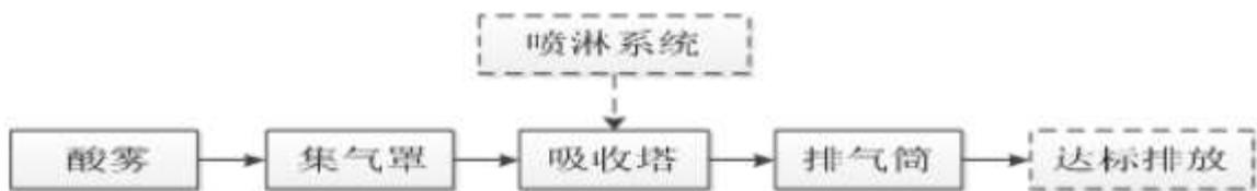
图 3.2- 4 酸雾处理工艺流程图
